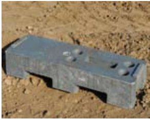
Recyclingfuß mit Gabelstapler- aussparung. 19 kg. Maße 770 x 250 x 160 mm
