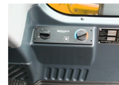
Heizung mit leistungsfähigem, 3-stufigen Gebläse
