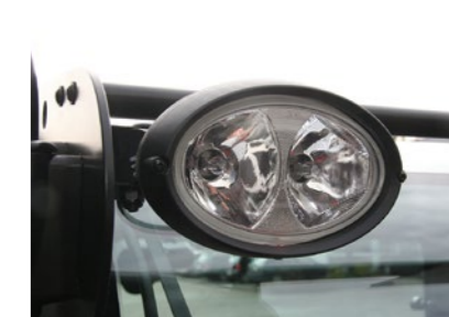
2 x Dual Power Arbeitsscheinwerfer vorne, 1 x Single Power hinten
