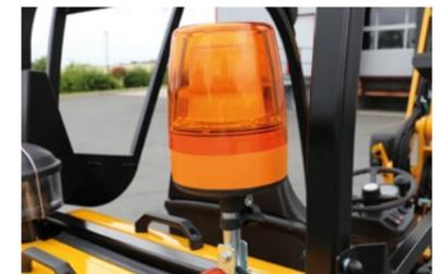
Die optionale Rundumleuchte wird in geschützter Position untergebracht.
