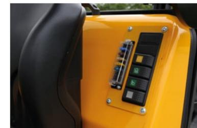
Die elektrischen Sicherungen können einfach kontrolliert und ausgetauscht werden.
